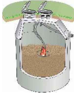
Abbildung 7: Erdlager aus Beton mit Saugentnahme von oben
